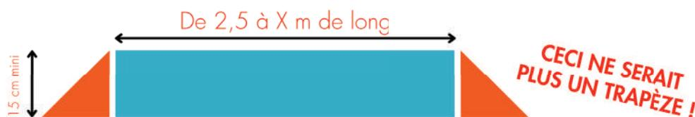
Qu'on le rebaptise « plateau ralentisseur », « plateau ralentisseur » ou « plateau surélevé », un ralentisseur reste trapézoïdal et doit respecter le décret 94-447 et la norme NF 98-300.
